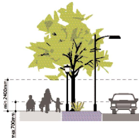
NO TREES OR VEGETATION SHOULD BE PLANTED TO BLOCK THE FIELD OF VISION BETWEEN 0.7 METRE AND 2.4 METRES ABOVE GROUND LEVEL.
